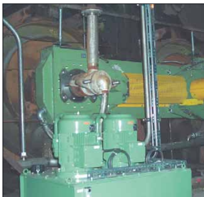
FlexoGearSystem en version Duo avec un système de lubrification
