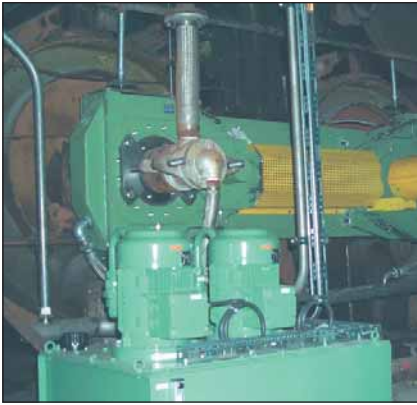
FlexoGearSystem in der Duo-Version mit Öl-Umlaufschmieranlage
