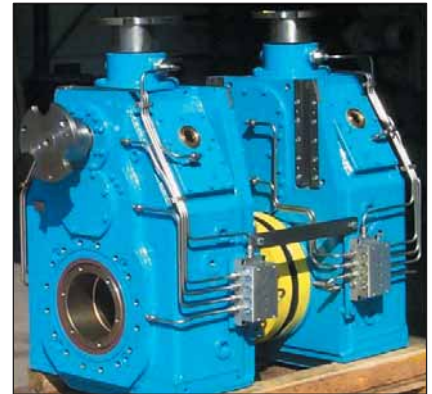
FlexoGear 320: 2-stufiges Getriebe, geeignet für große Übersetzungen. Gut sichtbar sind die Öl-Zuläufe, die alle Einbaulagen ermöglichen.
